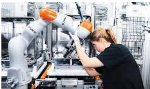
图 21 协作机器人功率和力限制示意图
