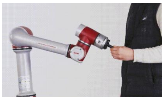
图 19 协作机器人手动引导示意图
