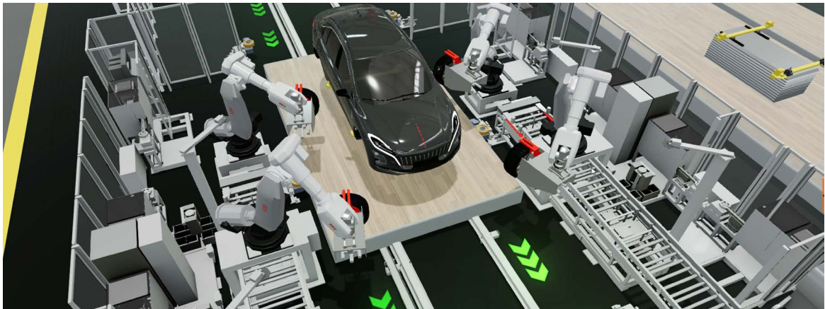
图 5-8 汽车总装产线的数字孪生图
