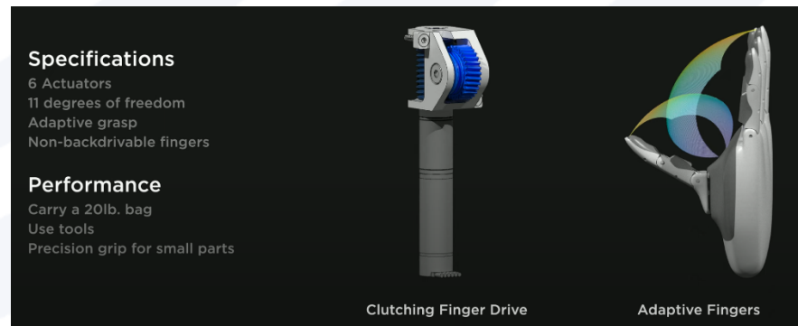
图表：2022年公布特斯拉机器人手部参数
