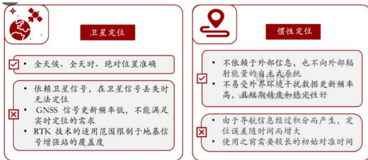
图34：卫星定位惯性定位的优缺点
