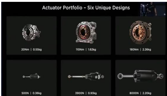
图60.特斯拉的六种执行器参数
