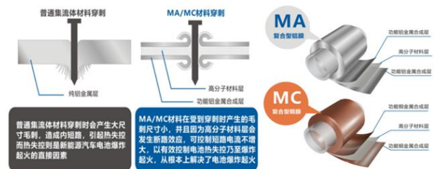
图77.传统集流体与复合集流体材料穿刺示意图
