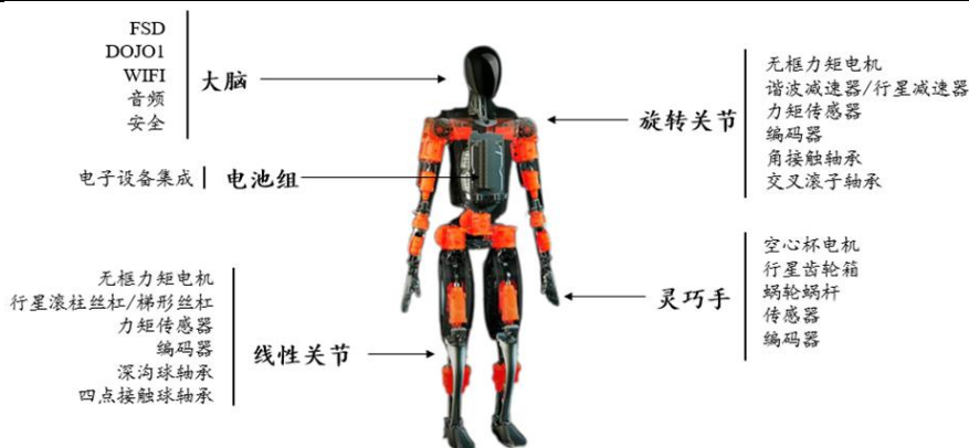
图87： 特斯拉 Optimus 2024 年 10 月通过单一神经网络学习了多种日常技能
