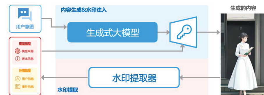
图 3-18 数字水印的应用流程
