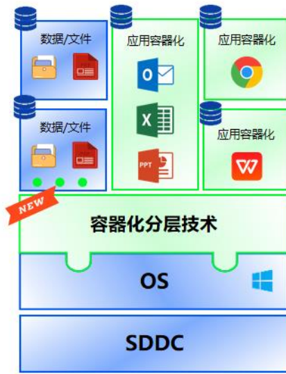
图 2-5 深信服桌面云容器化分层技术示意图
