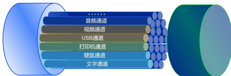
图 1-3 VDI 网络传输协议各个传输通道
