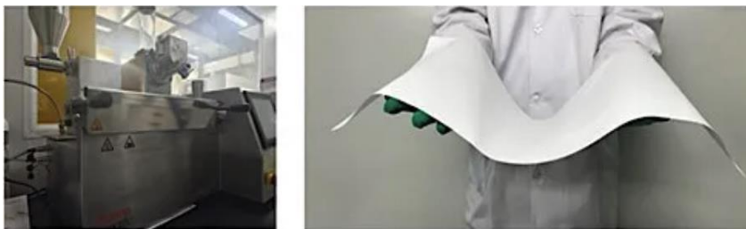
图：中科深蓝汇泽超薄硫化物/聚合物复合电解质膜
