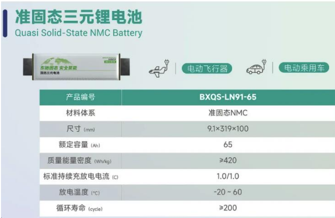
图：东驰能源准固态三元锂电池
