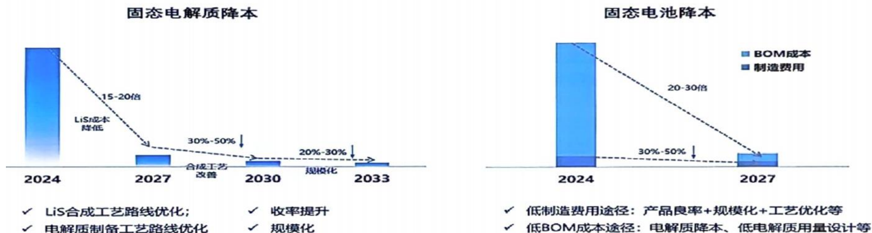
图：固态电池成本随着工艺成熟、规模化将会大幅降低（弗迪电池）
