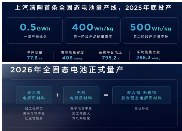
图：上汽清陶聚合物-无机物复合材料路线
