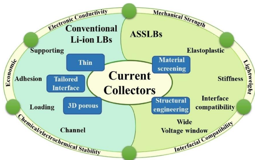
图：传统液态电池与全固态电池集流体选择原则
