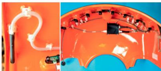
图4 管式碰撞传感器、红外传感器
