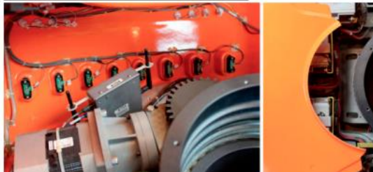
图2 前壳内部红外传感器组、后壳顶部视图
