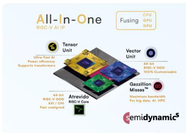
Fig.76 All-In-One RISC-V AI 芯片架构: Tensor+Vector+Core 三位一体
