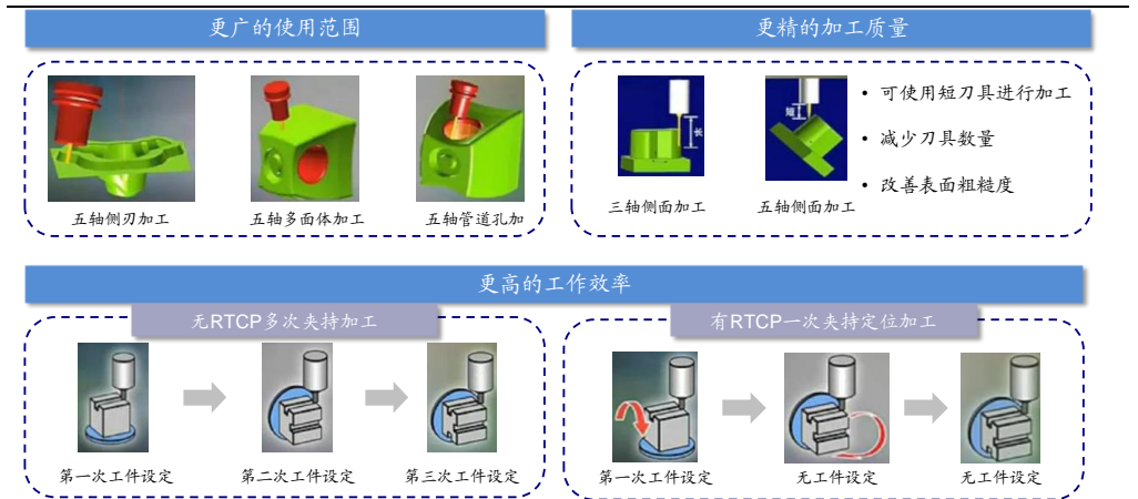
图26 五轴机床相较于三轴机床具有适用范围广、加工质量精、工作效率高等优点
