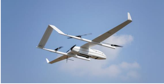
图53 公司 CW-25E 长航时电动固定翼垂直起降无人机
