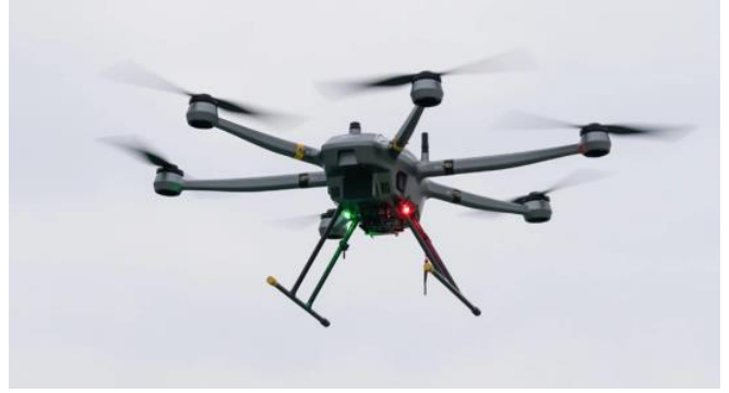
图54 公司 PH-20 大载重多旋翼无人机
