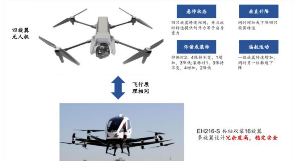
图41 四旋翼无人机飞行原理
