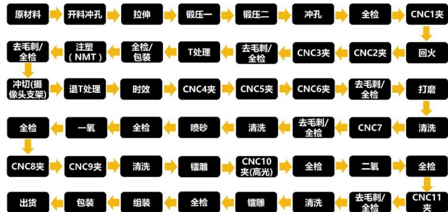
图52: 铝合金中框成型工艺
