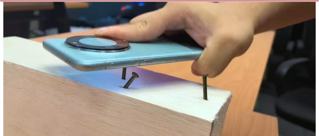
图42: 华为 mate 60 pro 昆仑玻璃盖板硬度测试
