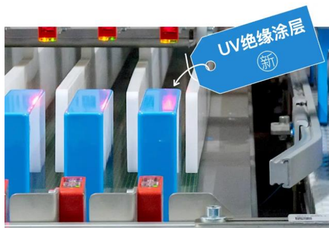
图50: UV 涂覆绝缘层
