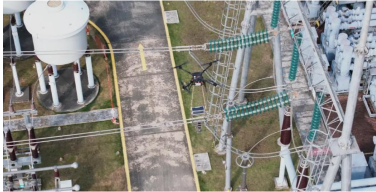
图35：公司“无人机+X光检测设备”检测高跨软导线耐张线夹作业现场
