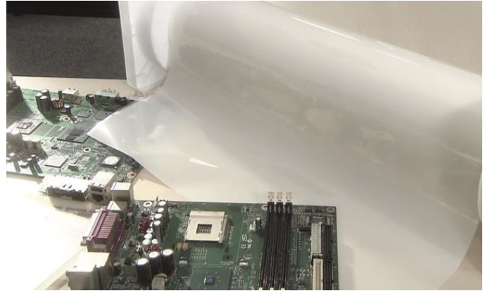
图11: ABF 材质在 FC-BGA 封装中的应用
