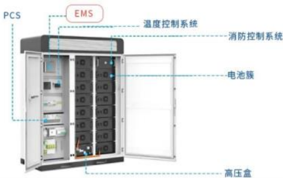
图1：储能一体柜构造图
