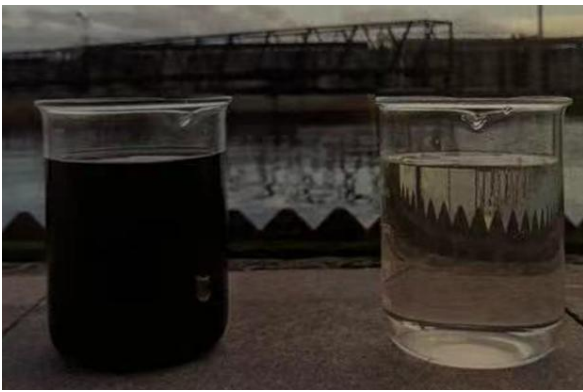
图27：电子束处理印染废水前后对比
