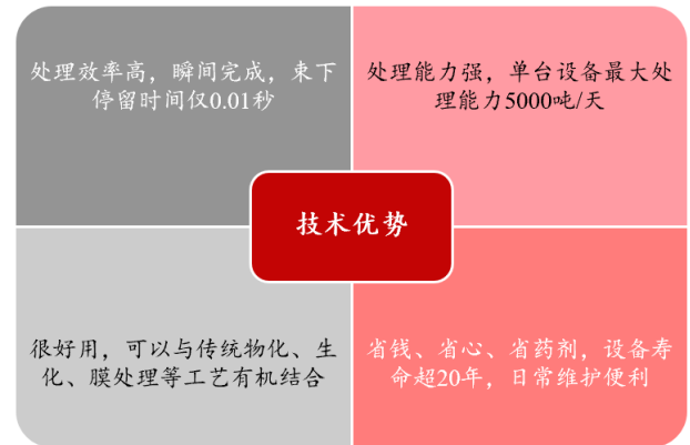
图28：“和美”电子束处理特种废物技术的优势
