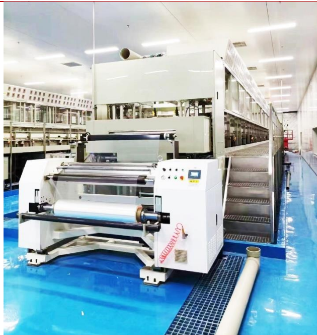
图45: 双边夹式水平连续镀膜设备
