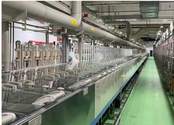
图43：东威科技“水平镀三合一”设备
