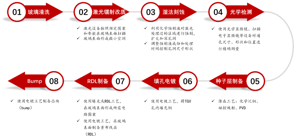
图49: 玻璃基板制备流程
