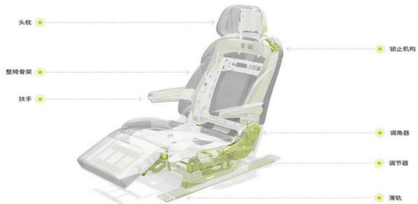
图 18、汽车座椅结构图
