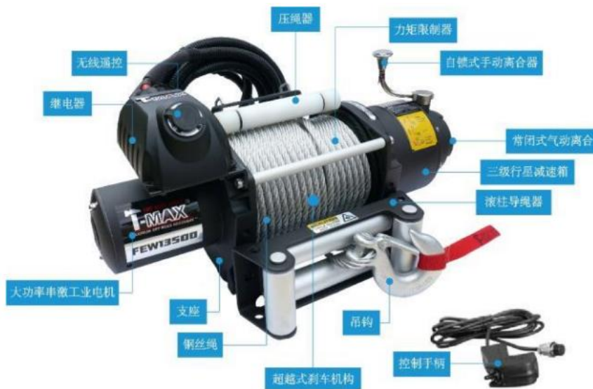
图 2、绞盘的产品结构图
