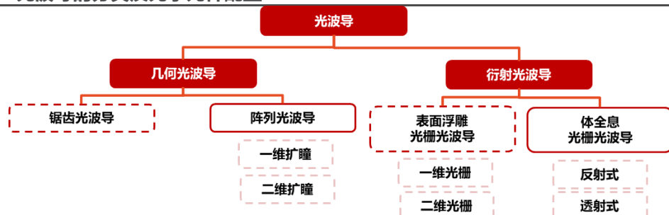
图66：光波导的分类及光学元件配置
