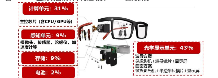
图60：AR 整机设备模块单元组成及 BOM 占比拆分
