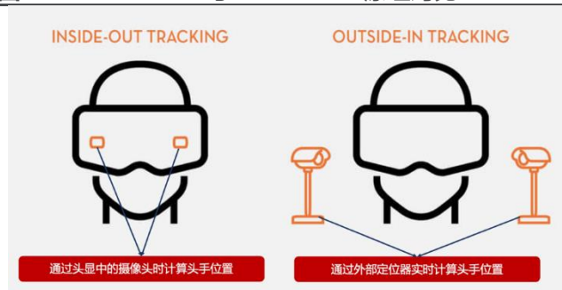
图54：Outside-in 与 Inside-out 原理对比
