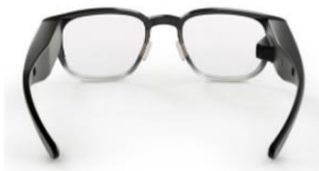
图65：North 公司研发的基于全息透镜方案的 AR 眼镜
