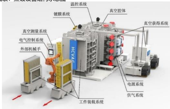
图表：蒸镀设备结构示意图
