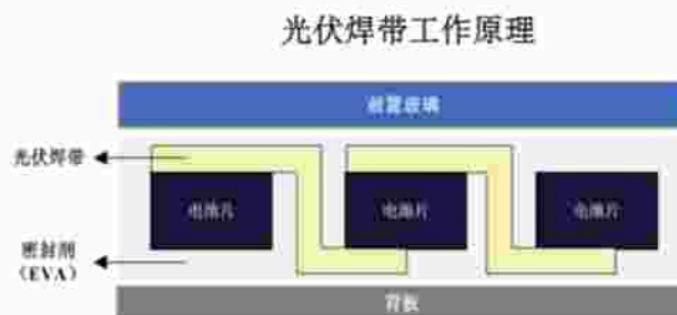
图101：光伏焊带工作原理
