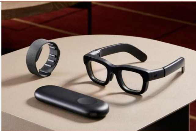
图 41: AR 原型机 Orin 由三部分构成
