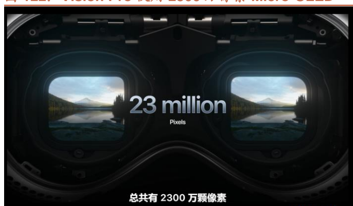
图 122: Vision Pro 使用 2300 万像素 Micro-OLED
