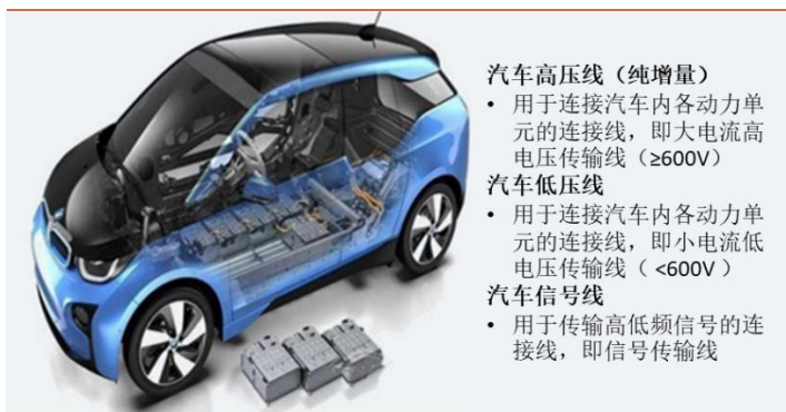
图 76: 汽车线在新能源汽车的应用
