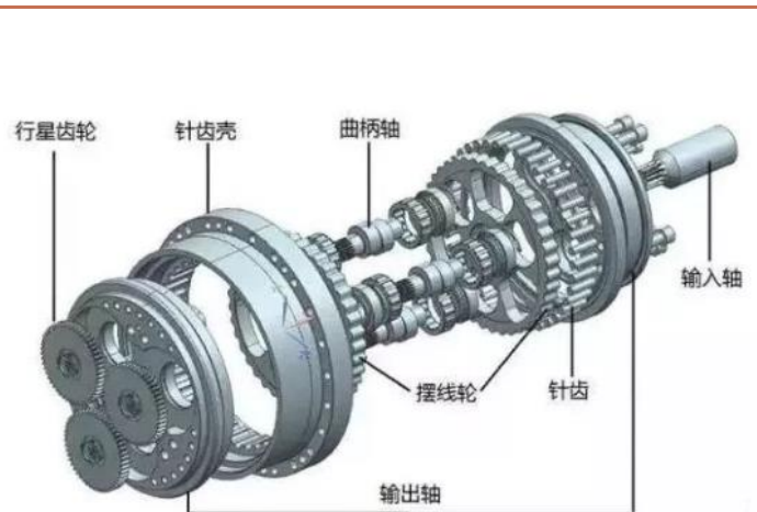
图 135: RV 减速器结构
