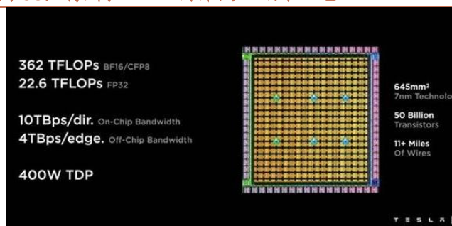
图 93: 特斯拉 D1 芯片采用 7 纳米工艺
