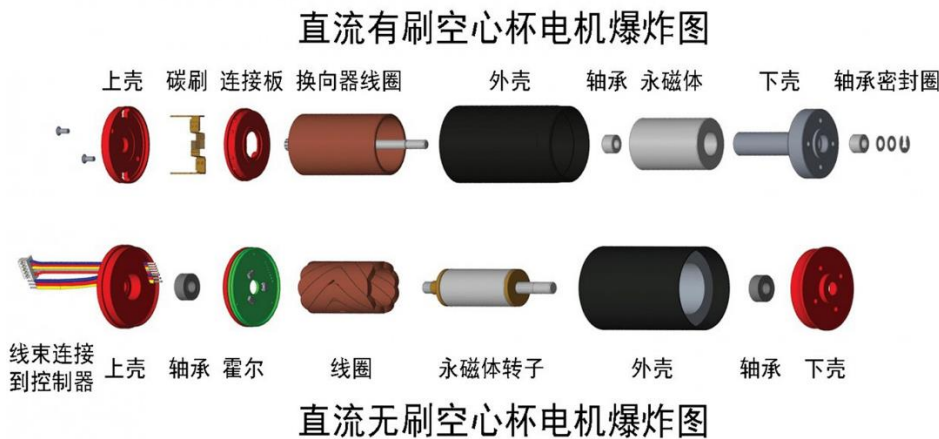
图 147: 空心杯电机结构示意图
