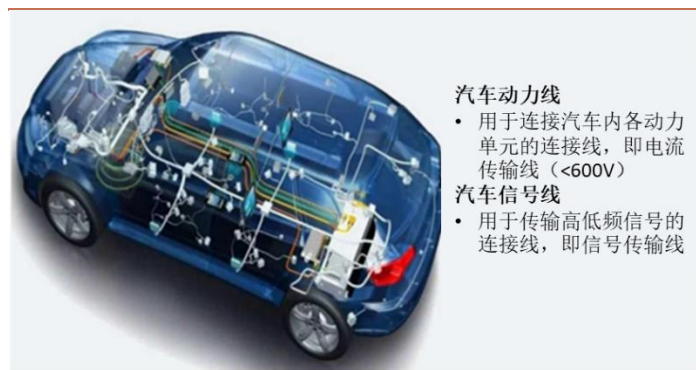
图 75: 汽车线在传统燃油车的应用
