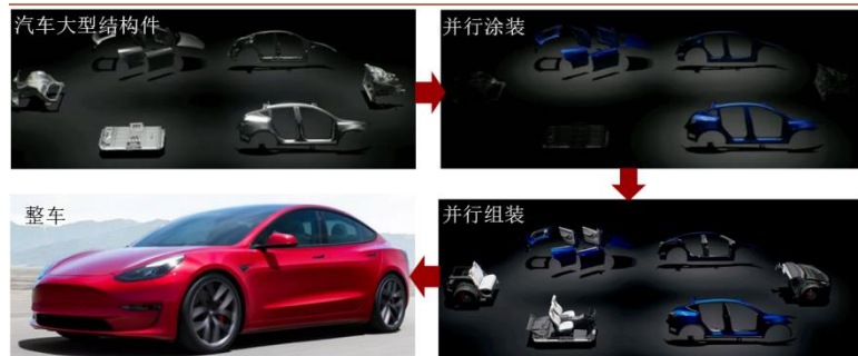
图 99：特斯拉由“串行”到“并行”改进涂装、总装
