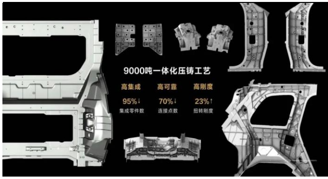
图21：玄武车身采用 9000 吨一体化压铸工艺
