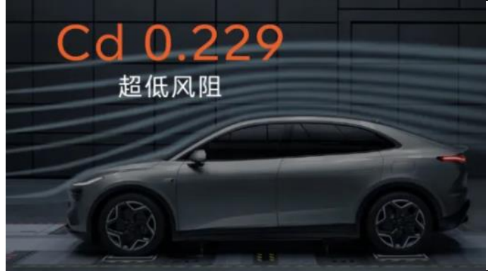
图15：整车车身具有 0.229Cd 的超低风阻
