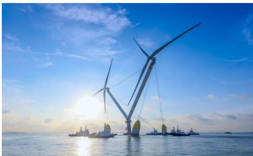
图表25 “明阳天成号”双转子漂浮式样机
