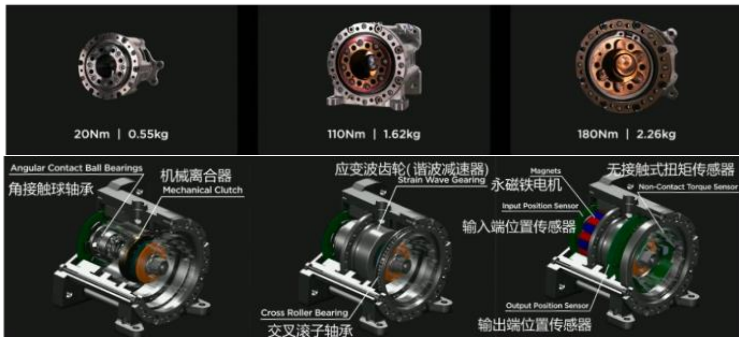
◎ Optimus采用的旋转关节执行器示意图
