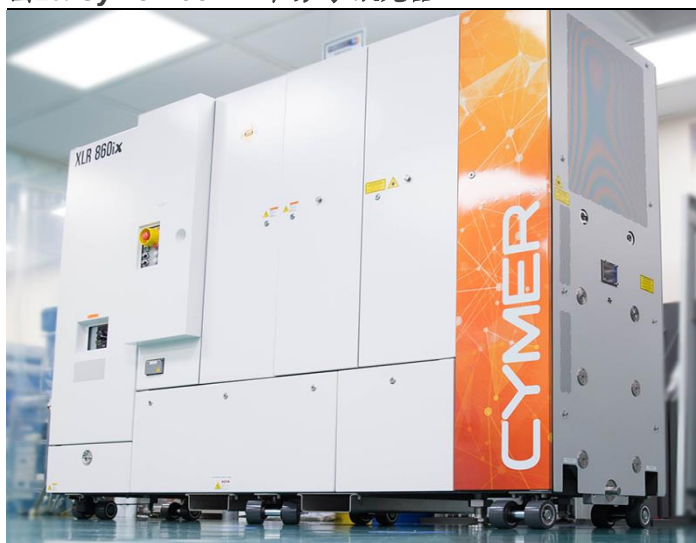
图20. Cymer193nm 准分子激光器
