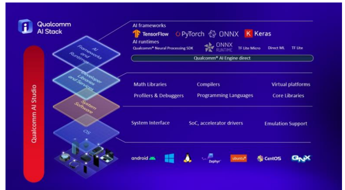
图21. 高通 AI 软件栈将 AI 软件统一到一个软件包中
