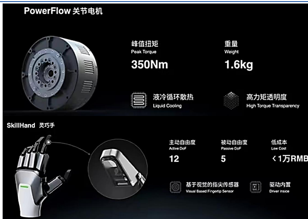
图表43：智元机器人自研的PowerFlow以及SkillHand核心部件
