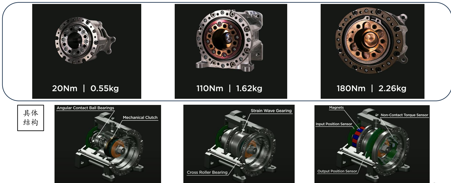
图表7：擎天柱Optimus的旋转执行器示意图
