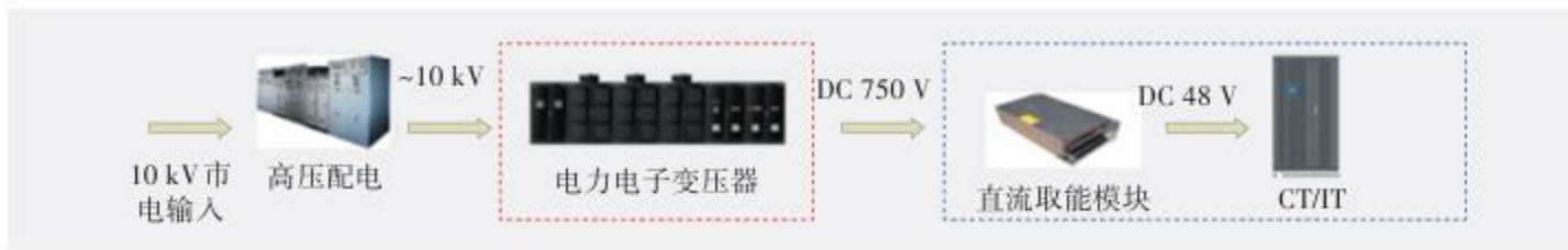
图：柔性直流供电系统架构
