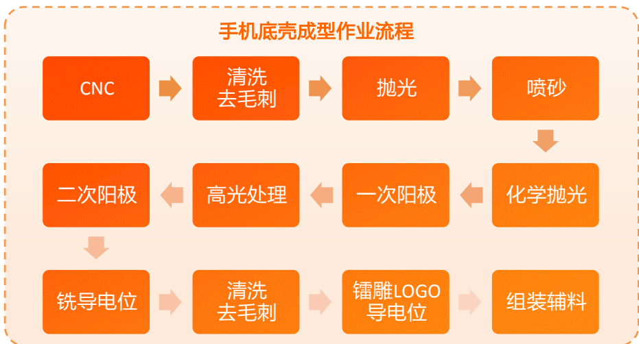
图：电子产品抛光研磨工艺流程
