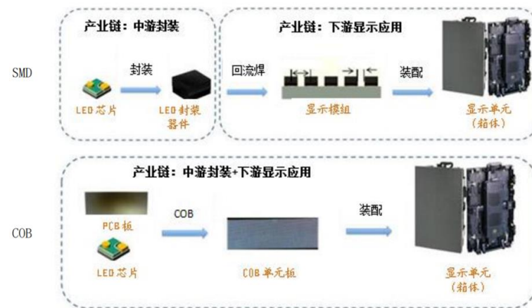
图：Mini LED显示屏SMD封装与COB封装结构示意图
