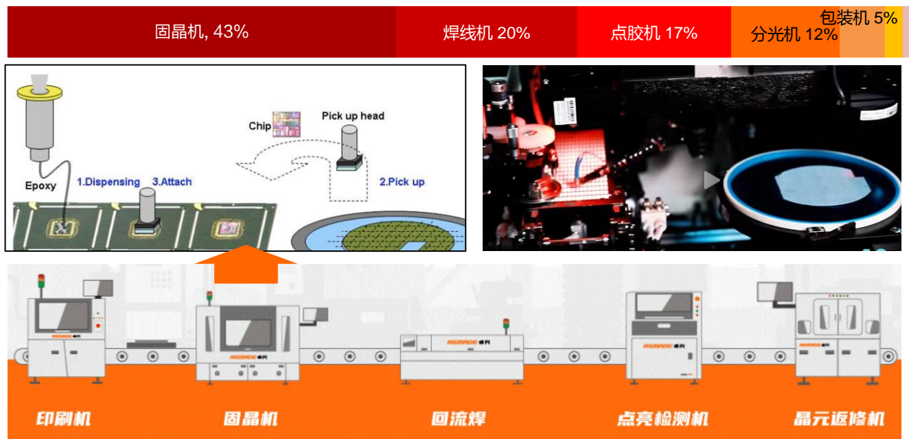
图：LED封装工艺流程与封装设备价值量占比
