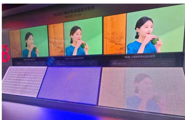
图 2：RGB-Mini LED 电视采用 RGB 红绿蓝三原色背光源
