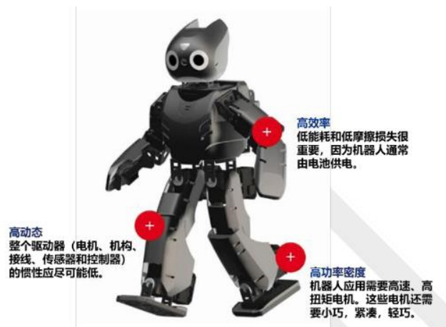
图：机器人电机侧重三点：高效率、高动态和高功率密度
