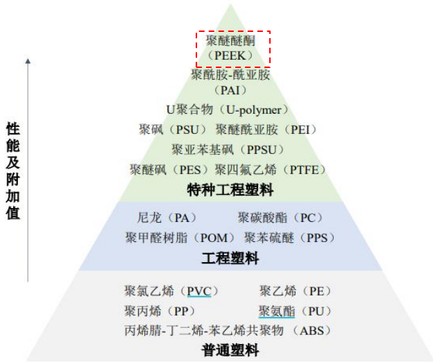
图：常用普通塑料、工程塑料及特种工程塑料示意图
