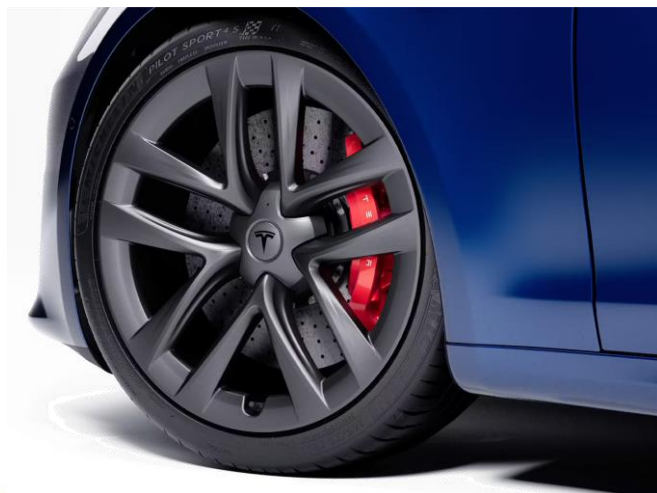
图：特斯拉ModelSPlaid应用了碳陶刹车产品
