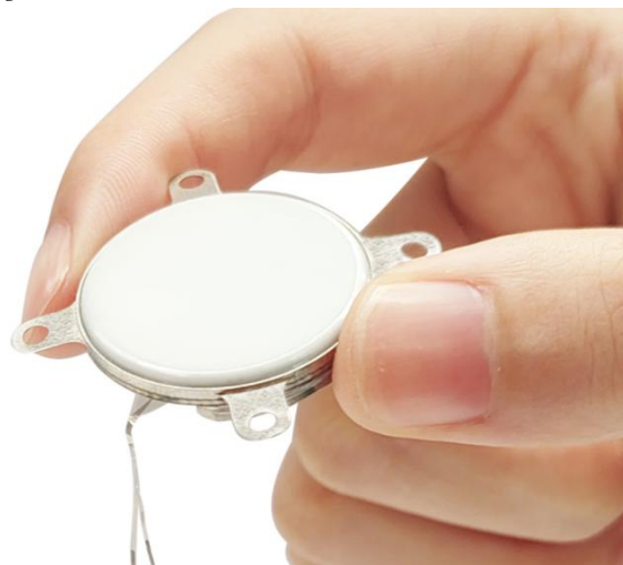
图：植入体直径26mm、厚度不到6mm，是全球最小尺寸的脑控植入体，仅硬币大小
