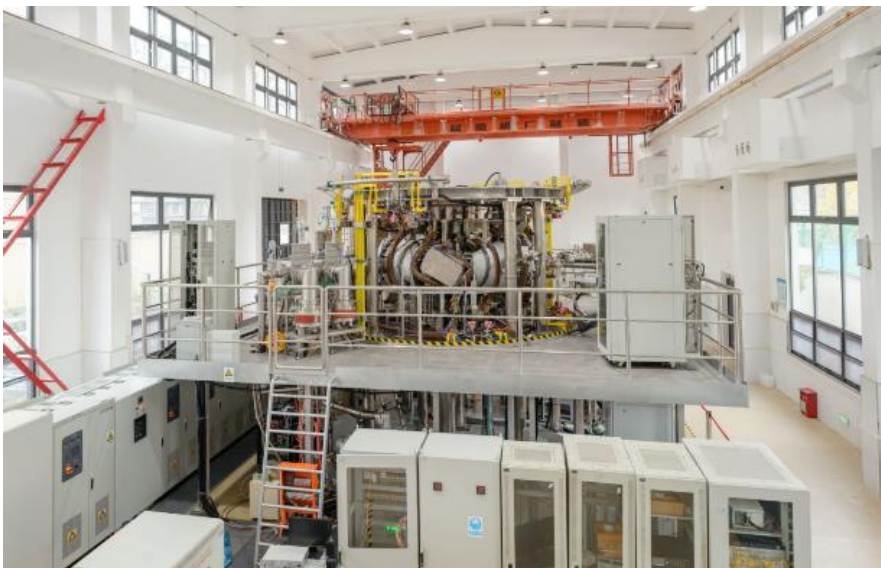
图：中国首台准环对称仿星器测试平台
