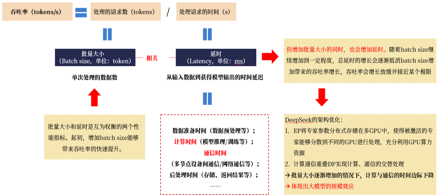
图表5: DeepSeek 进行架构优化后, 批量大小的增加将更有效地带动吞吐率的提升
