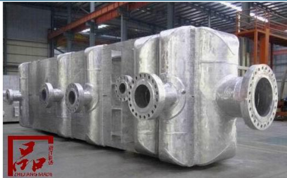
图表54: 铝制钎焊板翅式换热器示意图
