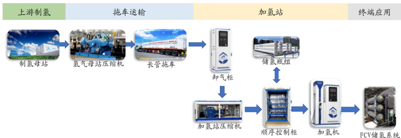
图表56：长管拖车气氢运输场景
