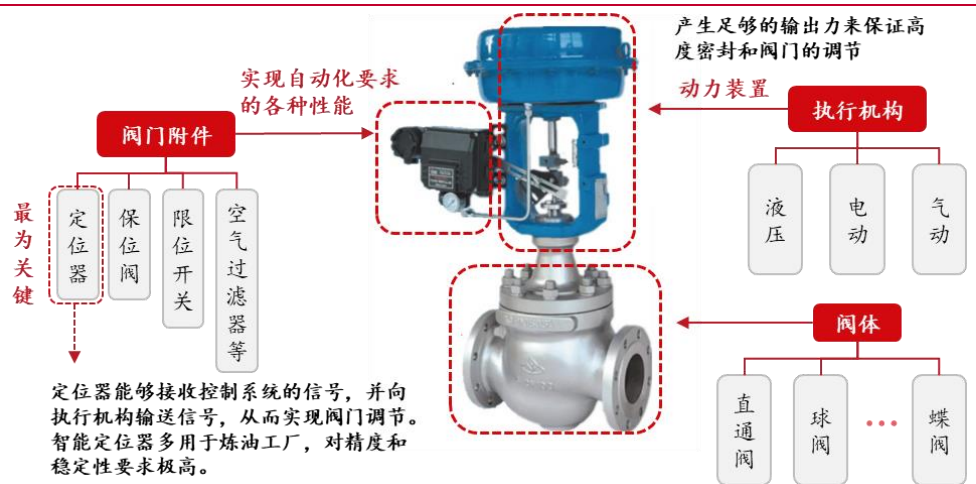
图表32：控制阀由执行机构、阀体及阀门附件组成
