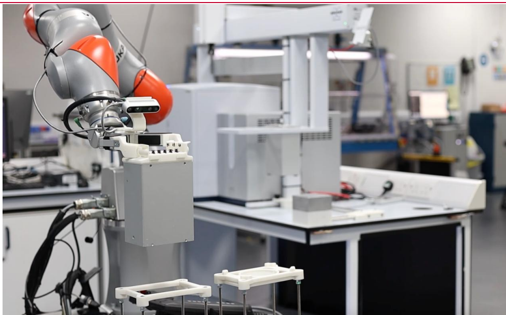
图表12: 近距离展示了单个光反应器小瓶从机器人底座转移到光反应器块的过程
