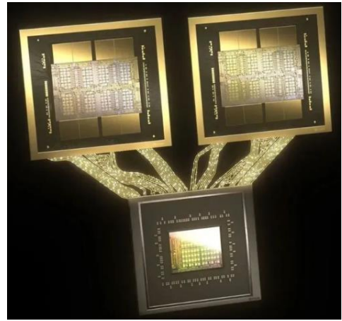
图表158: GB200 CPU 和 GPU 之间基于 C2C 互联
