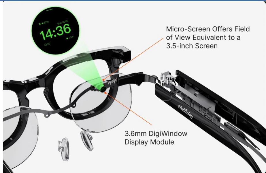
图表207: Halliday 在镜框部分塞入 Digi Window 微型显示器
