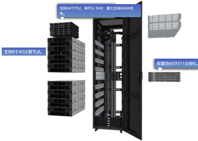
图表33: Atlas 900 A2 PoD 集群基础单元爆炸图 (1)
