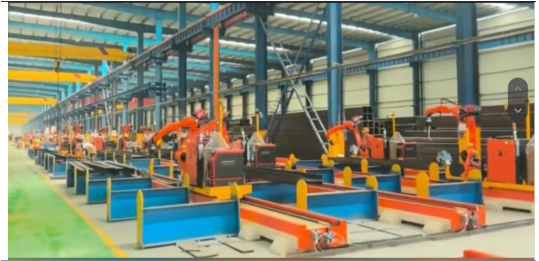
图表33: 鸿路钢构颍上基地 140 台焊接机器人实拍场景
