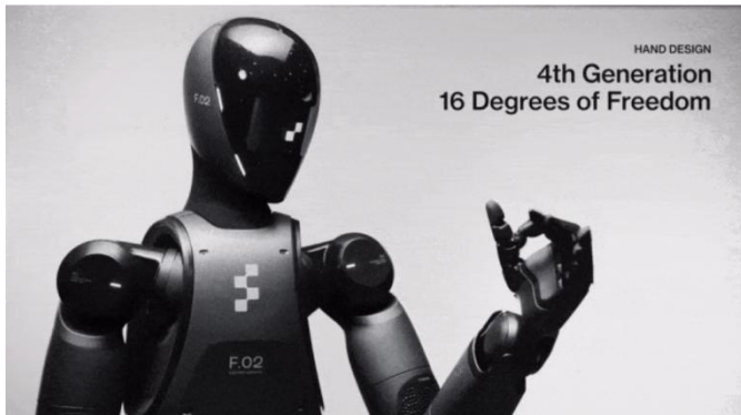
图表46: Figure 02 手部具有 16 个自由度
