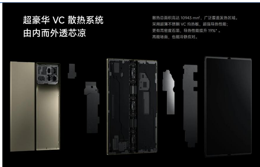
图表23: 小米 MIX Fold 3 配备不锈钢 VC
