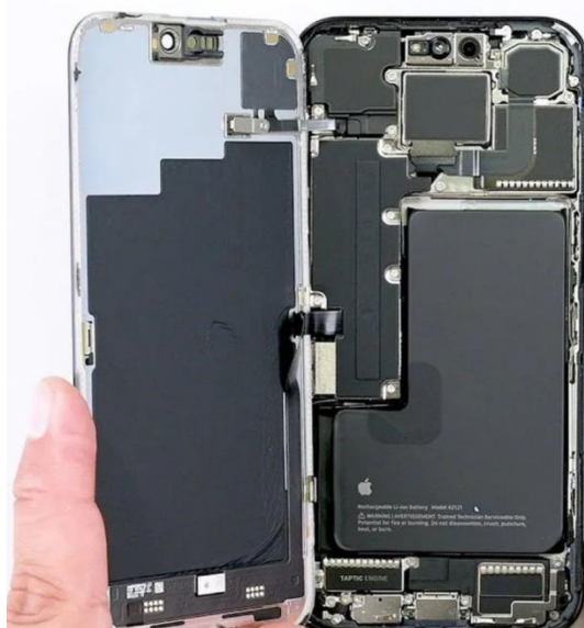
图表21: iPhone 15 Pro 系列采用最早的石墨片散热设计
